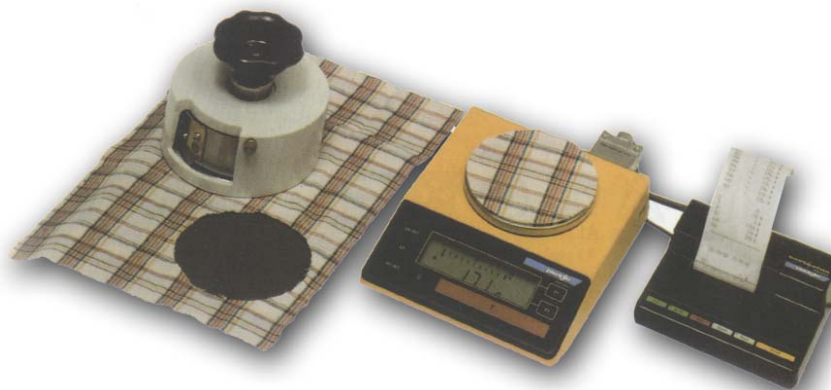
Tagliacampione circolare di 10 cm 2 (1 dm 2 ) e bilancia tessile con interfaccia per PC e stampante.
