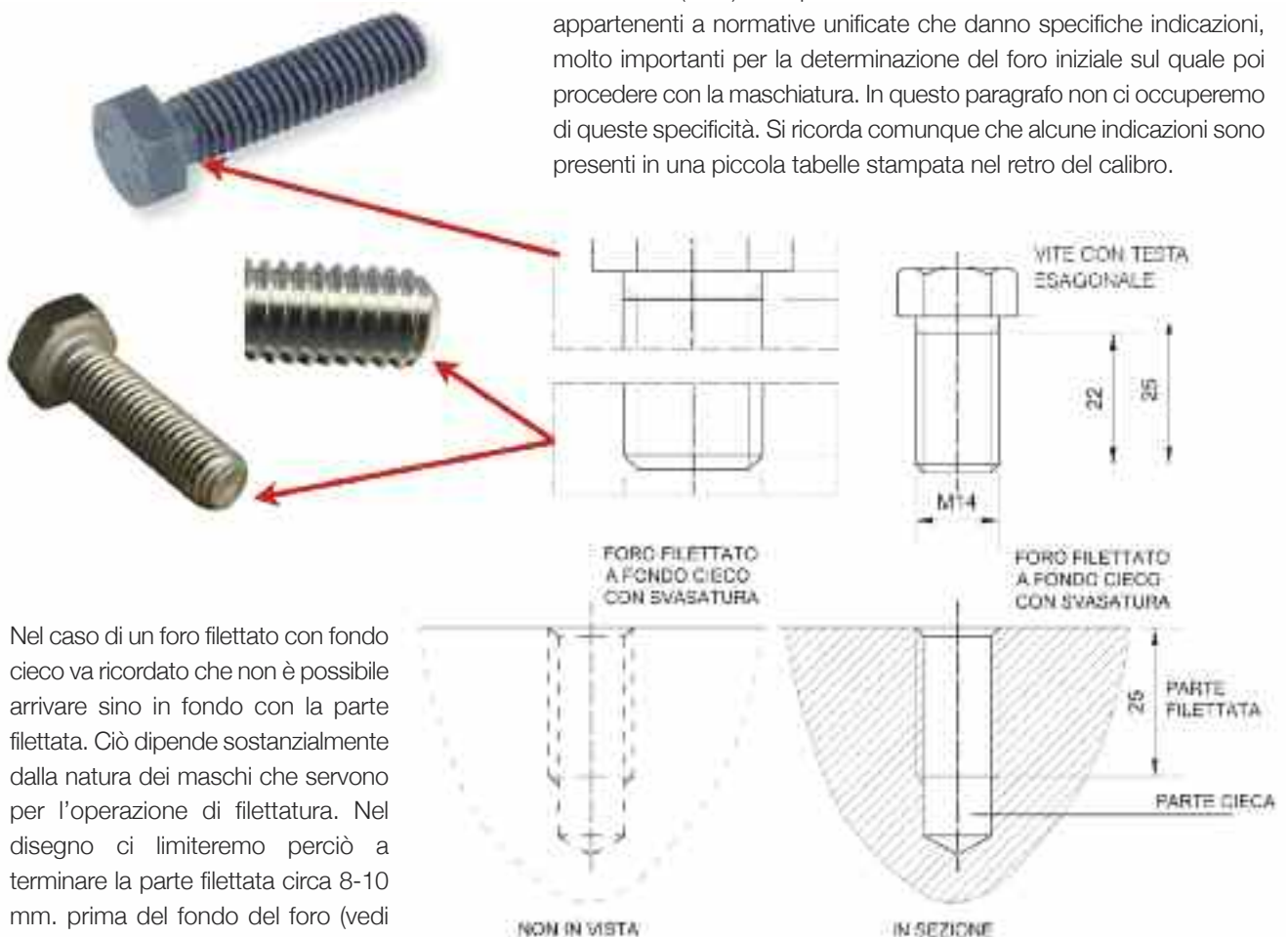
Figura 21: foro filettato a fondo cieco.
