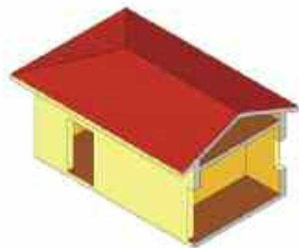
Figura 28: sezionamento con piano verticale ideale in corrispondenza delle parti significative
